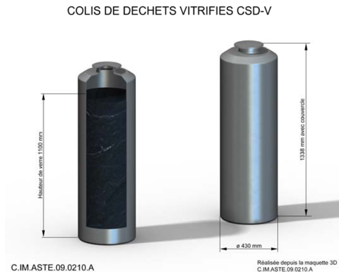
Figure 3 Conteneur standardisé de déchets vitrifiés (CSD-V)
