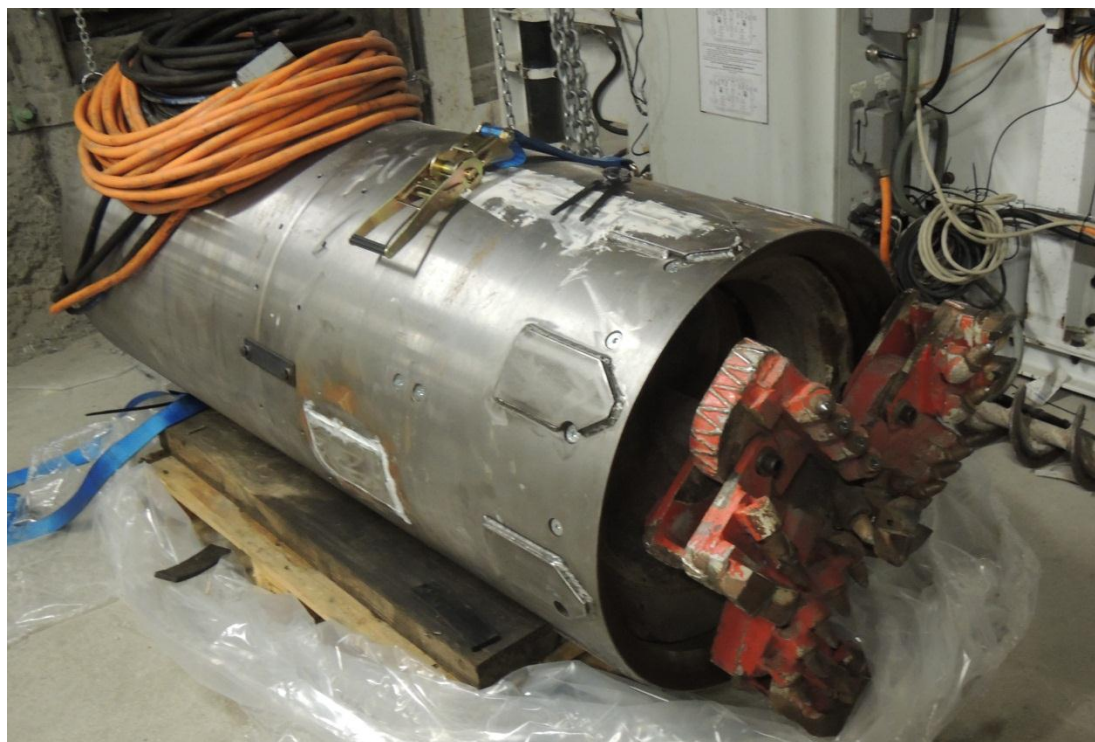
Figure 9 Tête de coupe pour le creusement des alvéoles, rétractable pour extraction par l'intérieur des chemises
