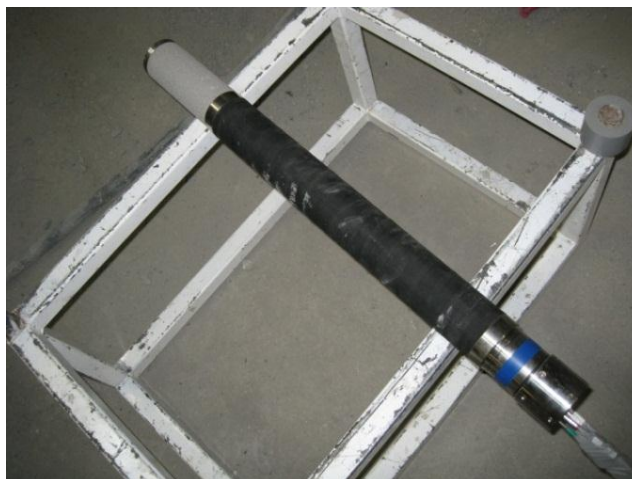
Figure 25 Complétion multi-packers installée dans le forage GGD4021 (zoom sur un packer et un intervalle de mesures)
