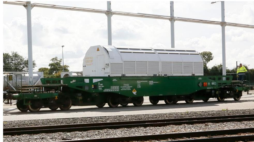
Exemple de wagon chargé d'un emballage de transport de matières radioactives recouvert d'un canopy
