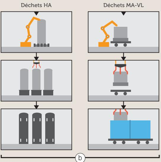
b Ils font l'objet d'un second contrôle et sont placés, si besoin, dans des conteneurs spécifiques pour le stockage : conteneurs en acier soudé de plusieurs centimètres d'épaisseur pour les déchets HA (haute activité) ; cubes de béton très épais pour les déchets MA-VL (moyenne activité à vie longue).
