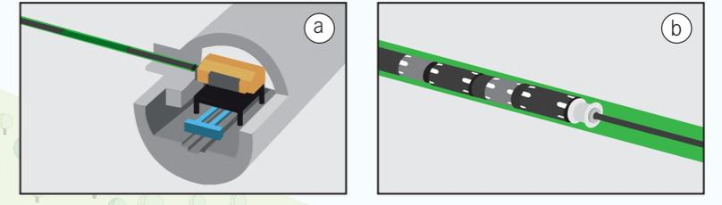
**4b Mise en place du colis MA-VL dans l'alvéole de stockage**
