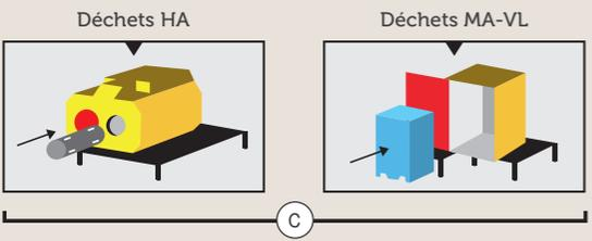
c Ils sont ensuite placés dans une hotte de transfert qui assure la radioprotection, avant d'être placés dans le funiculaire pour être descendus dans le stockage.
