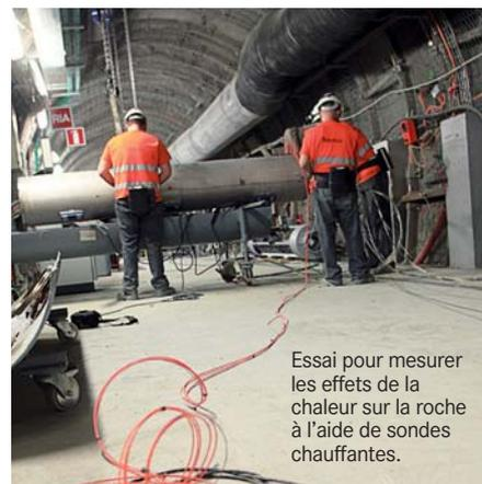
Essai pour mesurer les effets de la chaleur sur la roche à l'aide de sondes chauffantes.
