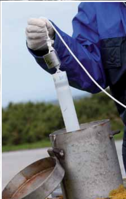
Ci-contre : Le ruisseau de la Sainte-Hélène. Ci-dessus : Prélèvement effectué dans un piézomètre.
