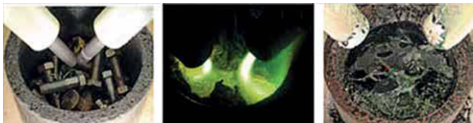
Figure 3 : Exemple d'essai de fusion/vitrification par voie plasma
