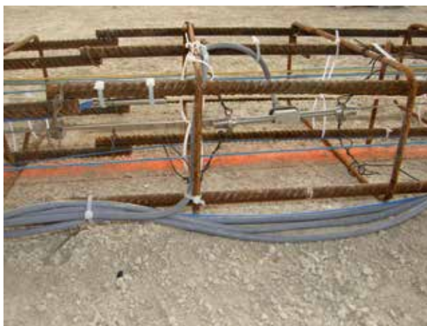
Figure 11 : extensomètre à corde vibrante
