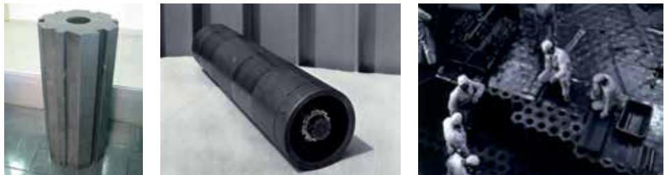
Figure 4 : Brique de graphite d'empilement (à gauche), chemise graphite (au centre) et empilement graphite du réacteur EDF Chinon A3 en cours de construction en 1965 (à droite). Les chemises en graphite contenant le combustible à base d'uranium naturel s'inséraient au centre des briques de graphite.
