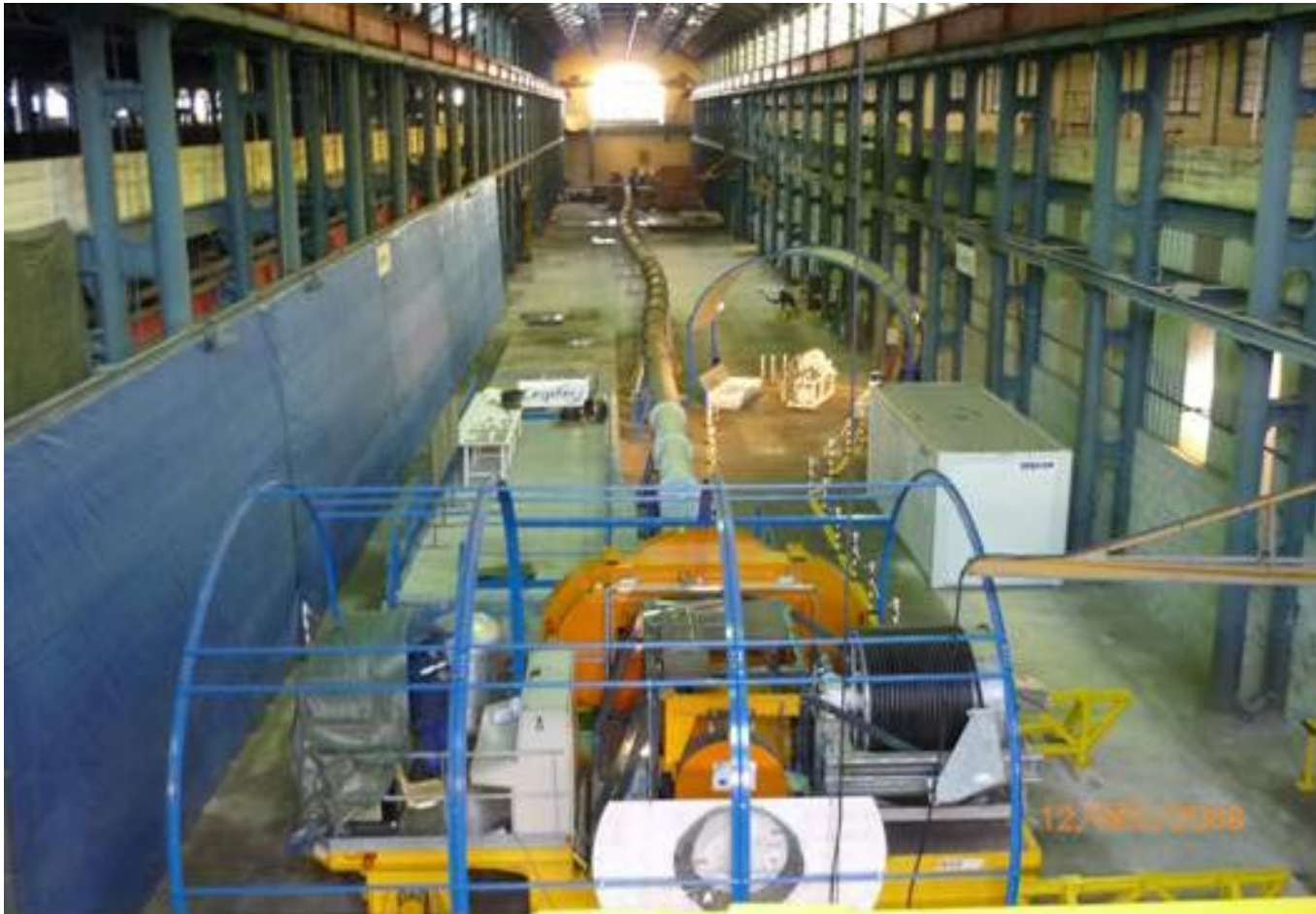
Test de manutention de colis HA avec simulation de grandes déformations de l'alvéole
