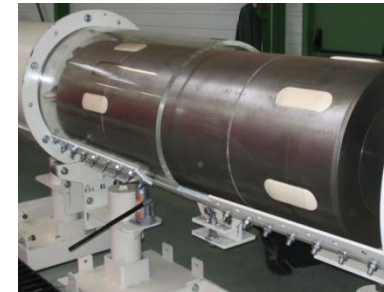
Colis de stockage de déchets HA
