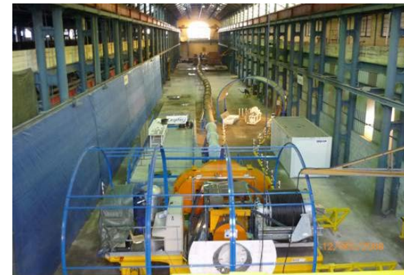
Test de retrait dans une alvéole déformée
