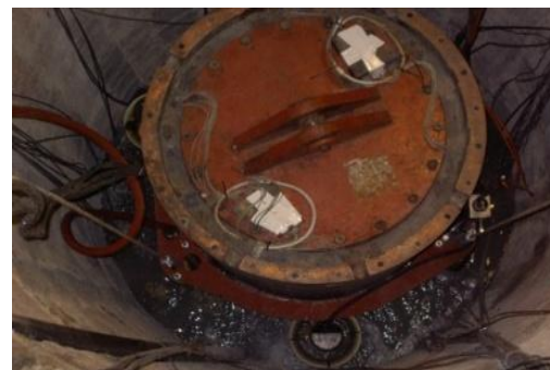
Essai de dépose des anneaux de bentonite en vue de la récupération de colis de déchets* en Suède (Äspö HRL, 2006)
