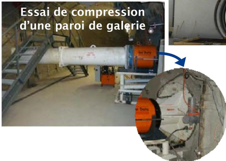
instrumentation d'un alvéole de 40 m
