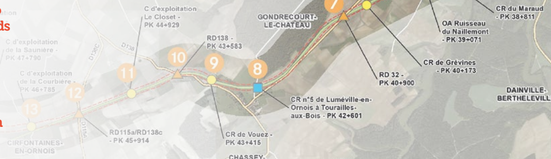
Le tracé de l'installation terminale embranchée (ITE) qui reliera Gondrecourt-le-Château à la future zone Descenderie de Cigéo. Quinze points de rétablissement des voies interrompues par l'ITE sont tout particulièrement à l'étude.
