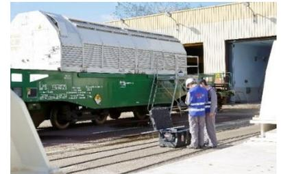
La réglementation limite également le niveau de contamination non fixée sur les parois externes du véhicules (4 Bq/cm<sup>2</sup> ou 0,4 Bq/cm<sup>2</sup> selon les radionucléides concernés).
