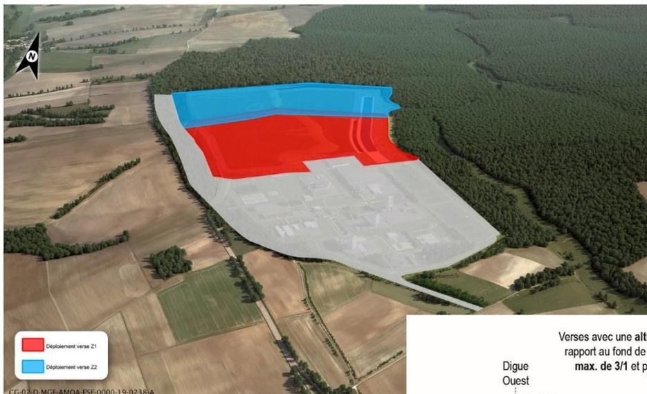
Dépôt progressif des matériaux issus des creusement des ouvrages souterrains (60 ha puis 50 ha supplémentaires). Ces matériaux seront nécessaires à la fermeture, à terme, de ces installations.
