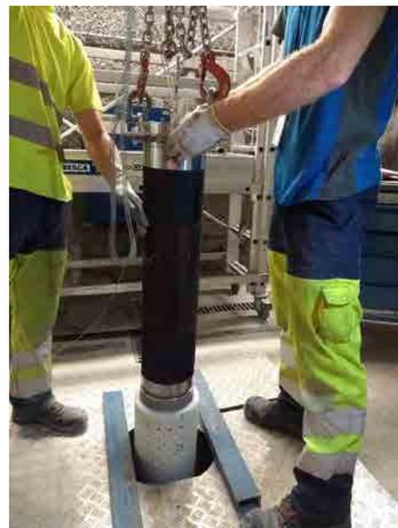
l'élément radioactif, sa vitesse de diffusion et la porosité à laquelle il a accès. Les forages périphériques sont équipés de capteurs de rayonnement qui vont mesurer l'évolution des teneurs en éléments radioactifs dans la roche au cours de l'essai. Ce dispositif avec les sondes in situ permet des mesures dans un plus grand volume de roche que celui d'une surcarotte.
