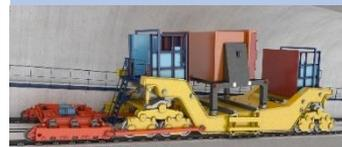
funiculaire conçu pour Cigéo et disposant d'une redondance des systèmes de freinage
