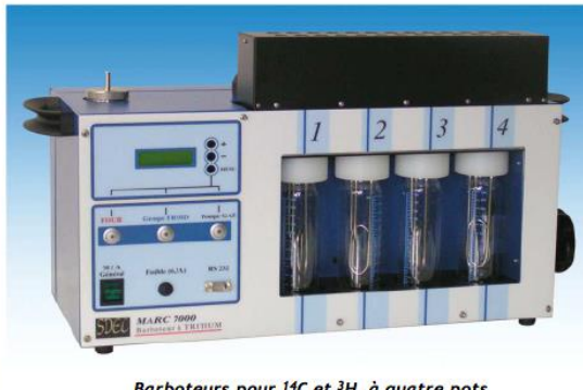
Barboteurs pour 14 C et 3 H, à quatre pots avec réfrigération des pots
