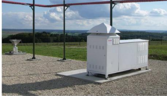
Station de filtration d'air à 300 m 3 .h -1 pour la quantification des radionucléides présents sous forme d'aérosols
