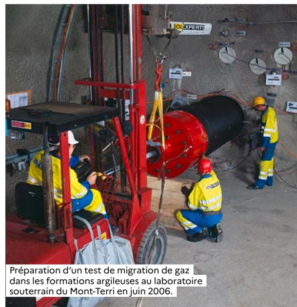
Préparation d'un test de migration de gaz dans les formations argileuses au laboratoire souterrain du Mont-Terri en juin 2006.
